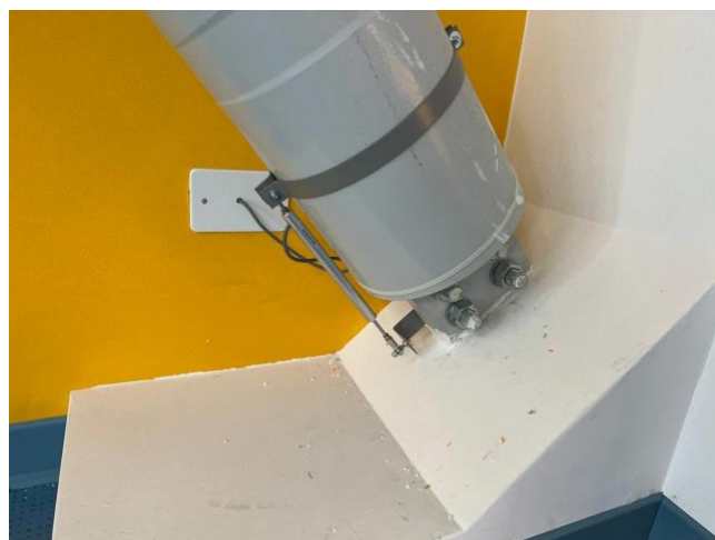
Misuratore di spostamento (potenziometro) ancorato ai dissipatori BRAD.
