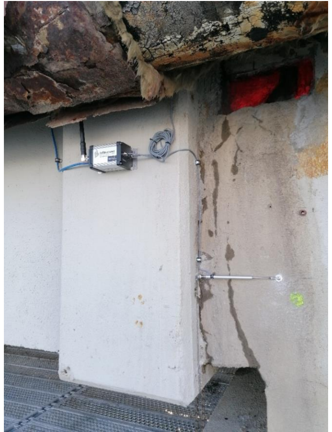
Unità di acquisizione con sensori di spostamento e temperatura.
