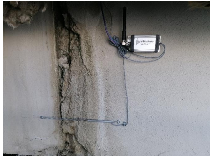
Unità di acquisizione con sensori di deformazione e di spostamento.
