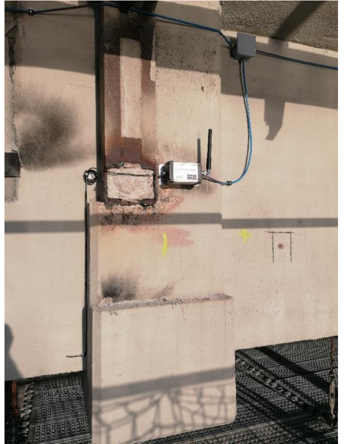
Unità di acquisizione con sensore di temperatura.
