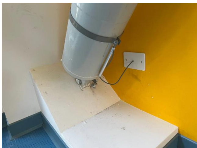
Misuratore di spostamento (potenziometro) ancorato ai dissipatori BRAD.
