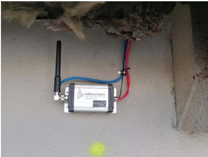
Unità di acquisizione con sensori di deformazione e di spostamento.
