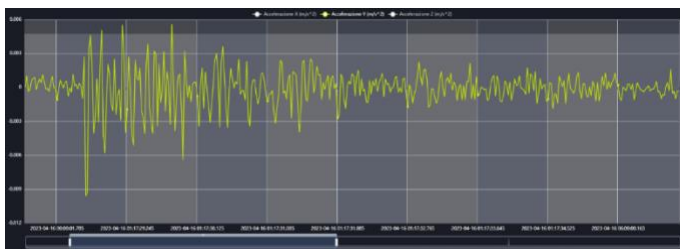
Accelerazione Ax, Ay e Az [m/s 2 ] alla base dell'edificio
