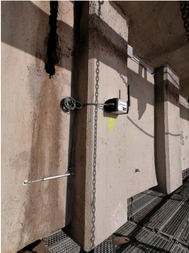
Unità di acquisizione con sensori di spostamento e temperatura.
