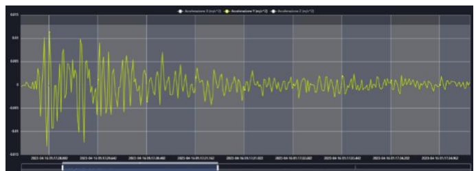
Accelerazione Ax, Ay e Az [m/s 2 ] alla base dell'edificio
