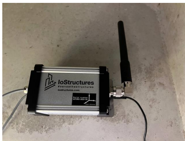
Campo controventato dissipativo monitorato e unità di acquisizione.
